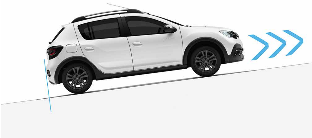
asistente de arranque en pendiente El asistente de arranque en pendiente (HSA) impide durante unos segundos que el vehículo retroceda, lo que facilita la seguridad en el arranque en pendientes.
