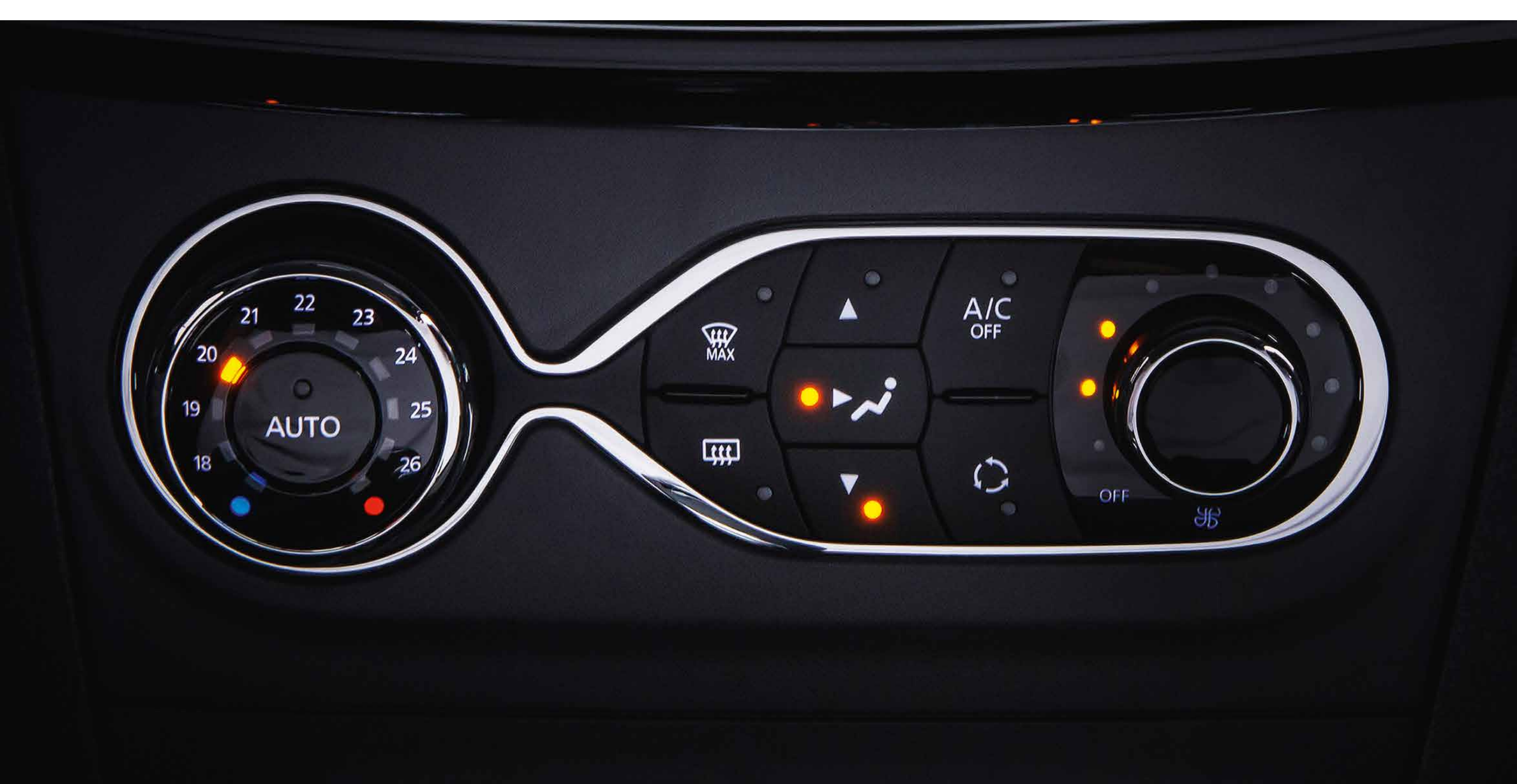
aire acondicionado automático
