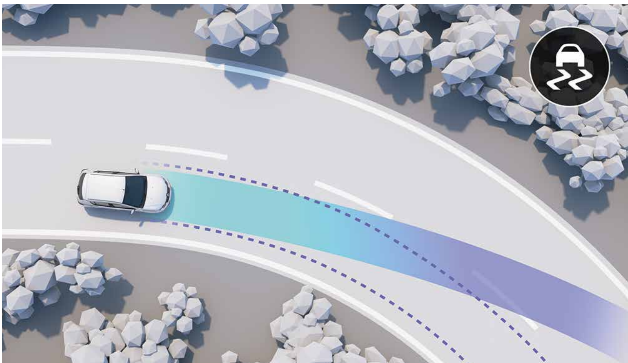
control electrónico de estabilidad El control de estabilidad ESP, es un sistema electrónico de control que permite corregir la trayectoria del vehículo para evitar derrapes en las curvas. Para que conduzcas con total seguridad.
